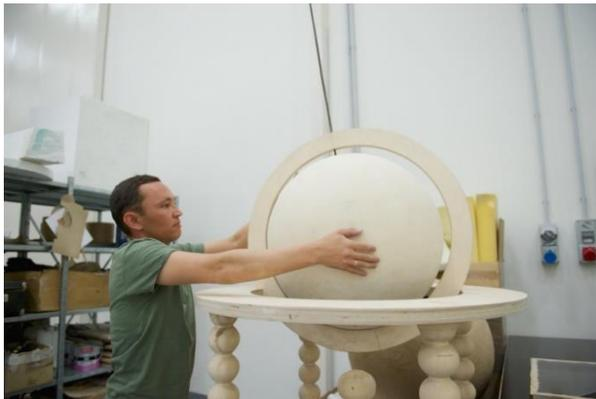
*К примеру, для изготовления такого глобуса потребовались брус, фанера, пенопласт, бумага, клей, шпатлевка.*
